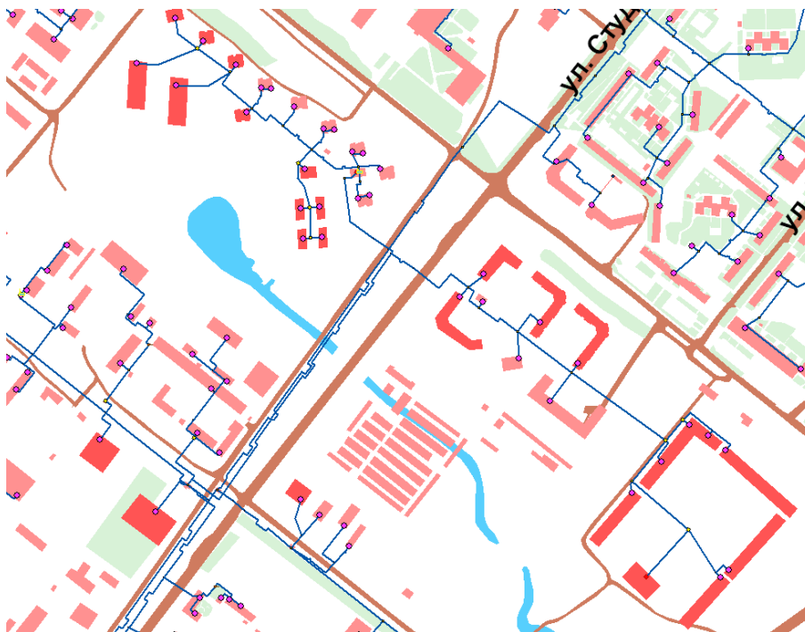
Рисунок 5.1.1. Схема подключения потребителей застраиваемых районов ЗПУ-2 и ЗПУ-5
