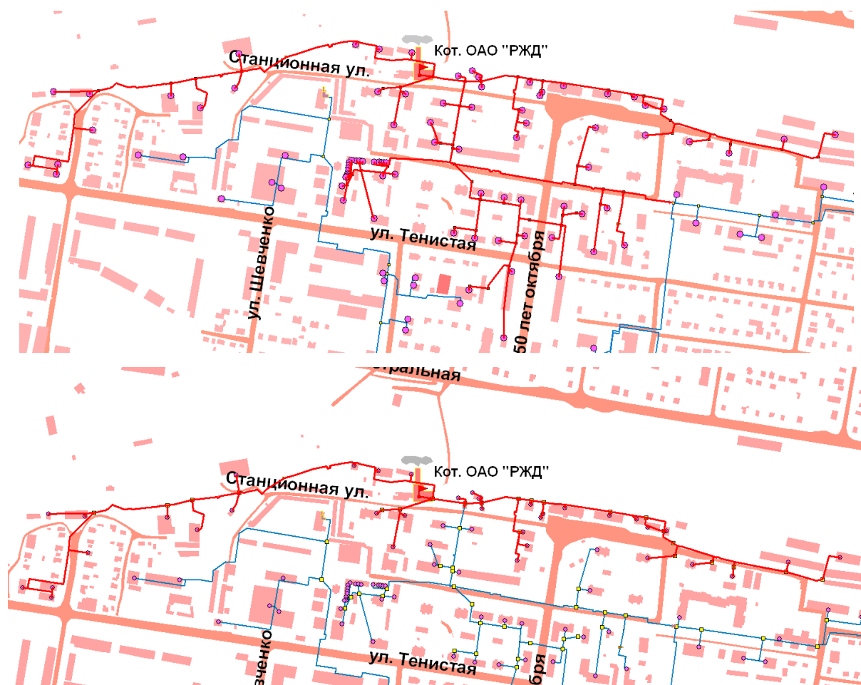
Рисунок 4.7.2. Схема переключения потребителей котельной ОАО «РЖД»
